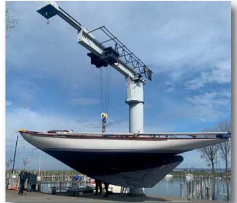
Der 8er Runag – unser Kranprüfungsgewicht mit 8 Tonnen
